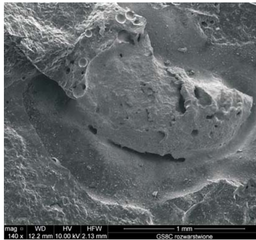
Rys. 9. Rozwarstwienie powstałe w pastylce nr 2 w trakcie szlifowania. SEM
