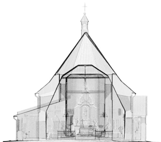
8.7 PRZEKRÓJ POPRZECZNY OBIEKTU W STRONĘ OŁTARZA - CHMURA PUNKTÓW
