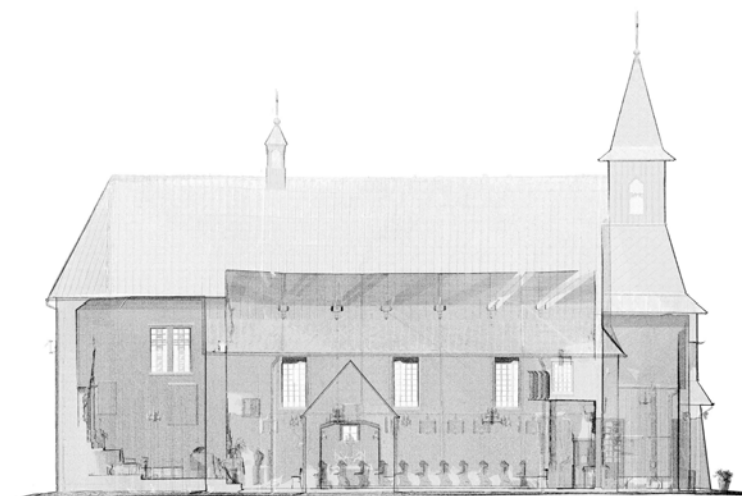
8.6 PRZEKRÓJ PODŁUŻNY OBIEKTU - CHMURA PUNKTÓW
