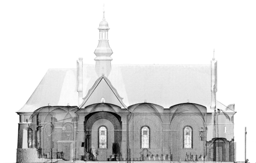
8.6 PRZEKRÓJ PODŁUŻNY OBIEKTU - CHMURA PUNKTÓW
