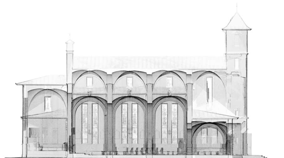
8.6 PRZEKRÓJ PODŁUŻNY OBIEKTU - CHMURA PUNKTÓW
