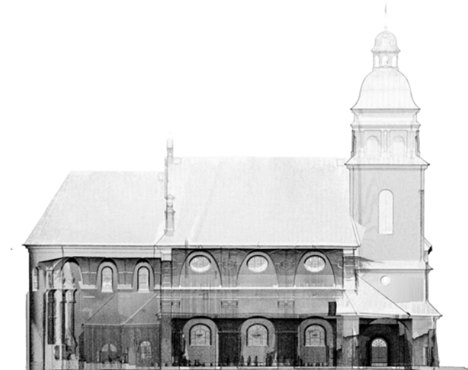
8.6 PRZEKRÓJ PODŁUŻNY OBIEKTU - CHMURA PUNKTÓW
