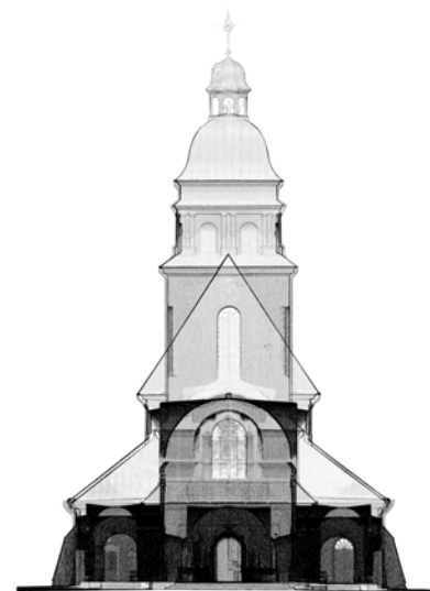
8.8 PRZEKRÓJ POPRZECZNY OBIEKTU W STRONĘ CHÓRU - CHMURA PUNKTÓW
