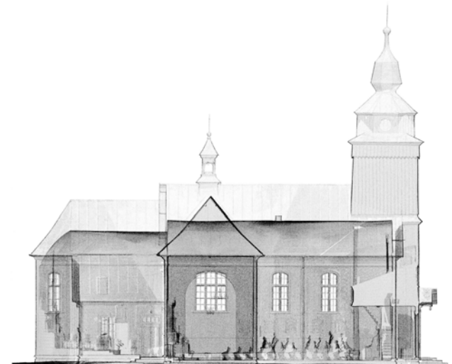
8.6 PRZEKRÓJ PODŁUŻNY OBIEKTU - CHMURA PUNKTÓW
