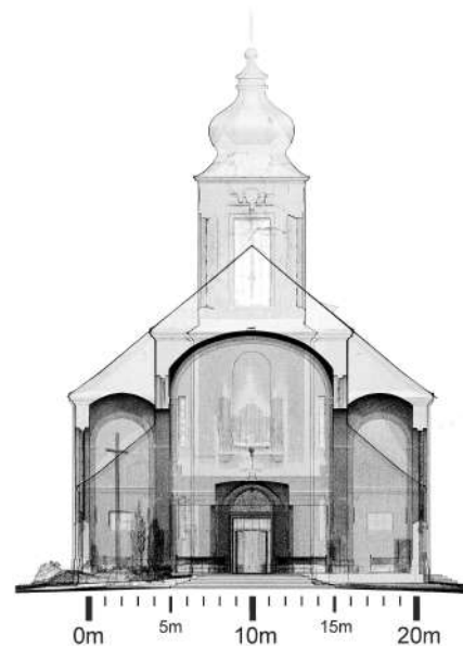
8.8 PRZEKRÓJ POPRZECZNY OBIEKTU W STRONĘ CHÓRU - CHMURA PUNKTÓW
