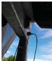
Rys. 6-3. Rozmieszczenie punktów pomiaru przyspieszeń i wymuszeń drgań: a) rozmieszczenie na rusztowaniu, b) akcelerometry na rusztowaniu podczas pomiarów
