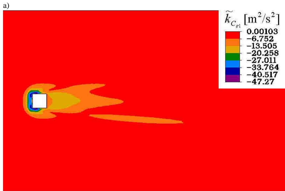
Rys. 4-10. Pola współczynników wrażliwości energii kinetycznej turbulencji k otrzymane metodą półanalityczną przy C_{\epsilon 1}=1.44 , C_{\epsilon 2}=1.92 , C_\mu=0.09 , \sigma_k=1.0 , \sigma_\epsilon=1.3 : a) na zmianę „stałej” C_{\epsilon 1} .
