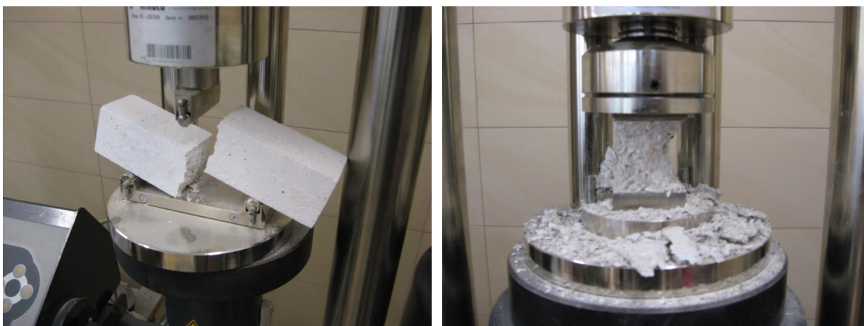
Fot. 3 Badania wytrzymałościowe betonu na kruszywie ze stłuczki ceramicznej: a) badanie wytrzymałości na zginanie, b) badanie wytrzymałości na ściskanie
