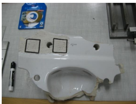
Rys. 1 Przygotowany do rozdrobnienia fragment uszkodzonej umywalki
