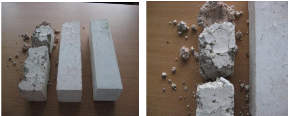
Rys. 6. Widok próbek po 30 dniach od zakończenia wygrzewania: a) widok ogólny, od lewej: próbka z kruszywem żwirowym, próbka z kruszywem granitowym, próbka z kruszywem z odpadów ceramiki sanitarnej; b) zbliżenie na uszkodzenia próbki z kruszywem żwirowym
